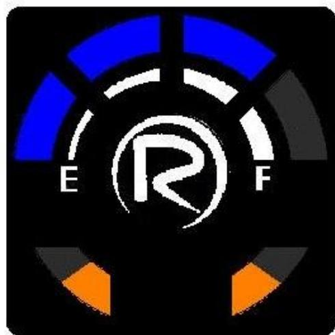
**B. 2 led inferiori di colore arancione lampeggianti con i led blu indicatori di livello gas accesi**
